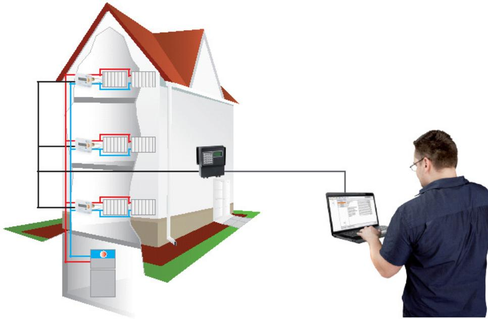
Il sistema **M-Bus** (*Meter-Bus*) è un sistema di trasmissione via cavo con cui diversi tipi di contatori (calore, acqua, elettricità, gas) possono essere letti a distanza da un'unità centrale.
